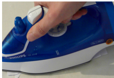
Figura 5: Trasferimento del toner sulla bassetta per mezzo del ferro da stiro
